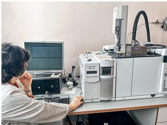
Анна Иванова за работой на хромато-масс-спектрометре Agilent 5975C
