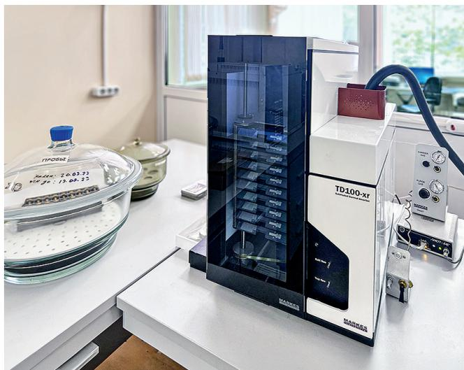
*Markes TD100-xr – автоматическая система двухстадийной термодесорбции для анализа проб, отобранных пассивным отбором на автоматических станциях мониторинга атмосферного воздуха в Санкт-Петербурге*
