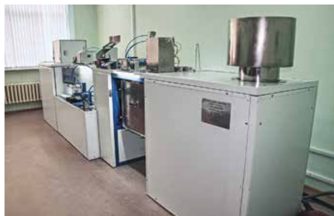
Рис. 1. Комплекс эталонной аппаратуры измерения эффективности фильтрации аэрозольных частиц
