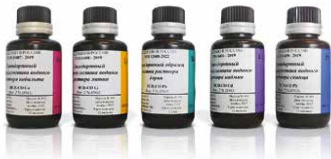
Рис. 2. ГСО ФГУП «ВНИИФТРИ» слева направо: ГСО 11407-2019 (ИСП-СО-Co); ГСО 11408-2019 (ИСП-СО-Li); ГСО 12008-2022 (ИСП-СО-Ba); ГСО 11406-2019 (ИСП-СО-Cd); ГСО 11409-2019 (ИСП-СО-Pb)
